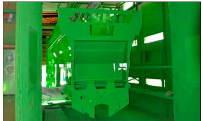
De mallen die gebruikt worden bij de montage in de fabriek zorgen voor precisie en snelheid bij de vervaardiging
