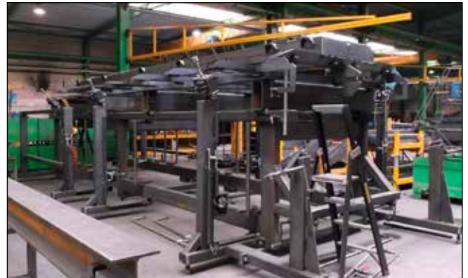
De mallen die gebruikt worden bij de montage in de fabriek zorgen voor precisie en snelheid bij de vervaardiging
